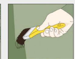
Zum dauerhaften Betonschutz: Zaun mit Beckers Betonzaun Farbe behandeln – idealerweise mit Lackiergerät. Farbe gut aufrühren, mit 10 % Wasser verdünnen. Zwei Arbeitsgänge nötig. Ergiebigkeit ca. 0,4 Liter/qm.
