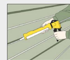
Für blickdichte und einheitlich geschlossene Optik: Zwischenräume der Plattenelemente mit Außenacryl versiegeln. Erforderliche Außentemperatur: ab 14° C.
