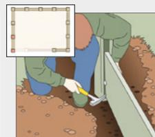
Motivseite an Pfosten drücken, Fuge mit Stein verkeilen. Bei doppelseitiger Bauweise: zwei Platten gegeneinander platzieren, zwischen den Platten verkeilen.
