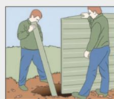
Zweiten Pfosten (Zwischenpfosten) passgenau an Elemente ansetzen, lotgenau ausrichten und einbetonieren. Beton für zusätzliche Unterstützung bis unter die Platten anfüllen.
